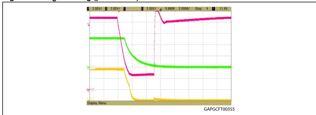
Figure 29. V_S cranking (pulse 5 ms)
