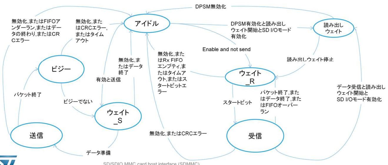
データパスステートマシン(DPSM)はすべてのデータ遷移と受信を制御しますコントロールする。DPSMがアイドル状態で、DPSM有効化ビットと転送方向が設定される時に、最初の送信が引き起こされます。
