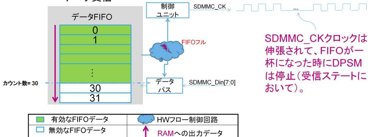
SDMMC\_CKクロックは伸張されて、FIFOが一杯になった時にDPSMは停止(受信ステートにおいて)。
