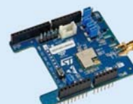
Nucleo 拡張ボード 品名:I-NUCLEO-LRWAN1 (ST & USI®社)
