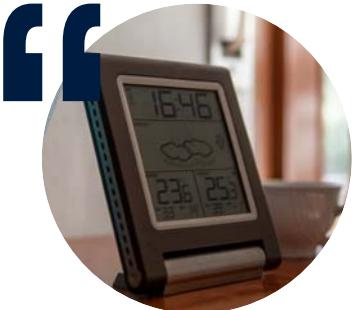
グラフィカルなE InkディスプレイとTouchGFXのフレームワークは、私たちの目標を達成するための手段でした。TouchGFXのSDKとツールチェーンは、高性能、使いやすさ、および当社の特定のディスプレイを制御するための優れた適応性を実証しました。また、迅速に実装し、開発段階に沿ってUIの変更をデモすることも可能でした。
