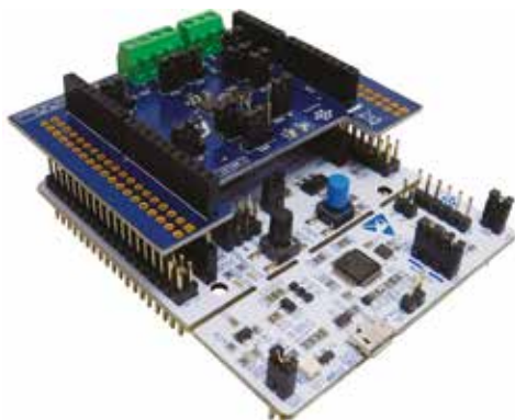
图10 – 将X-NUCLEO-IOD02A1扩展板 (位于顶部) 与NUCLEO-G071RB相结合的想法半导体解决方案示例。
