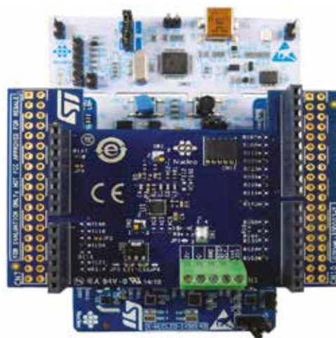
图7 – P-NUCLEO-IOD01A1套件由NUCLEO-L073RZ、X-NUCLEO-IKS01A2和STEVAL-IOD003V1组成（显示在顶部）
