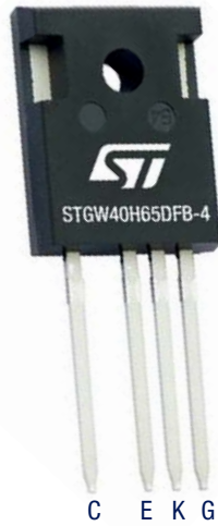
寄生インダクタンスを低減する電流パワー経路からの スプリット駆動：スイッチング・イベントの高速化
