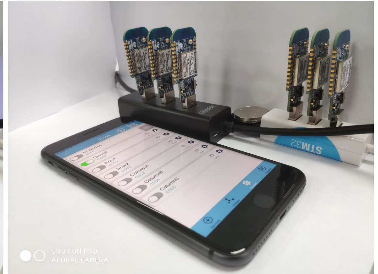
控制所有Mesh节点同时关灯
