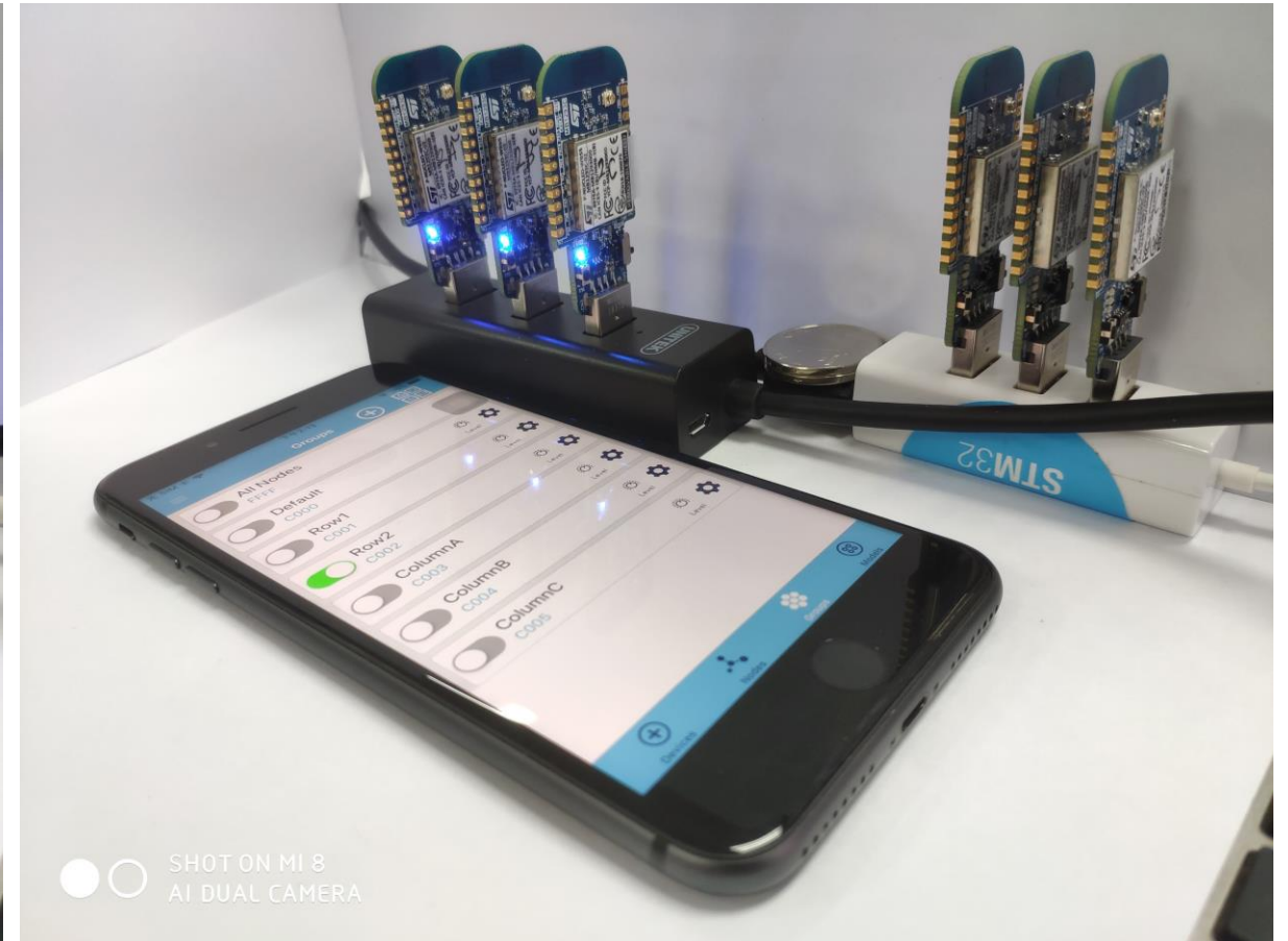
控制Mesh子网Row2中所有节点同时开灯
