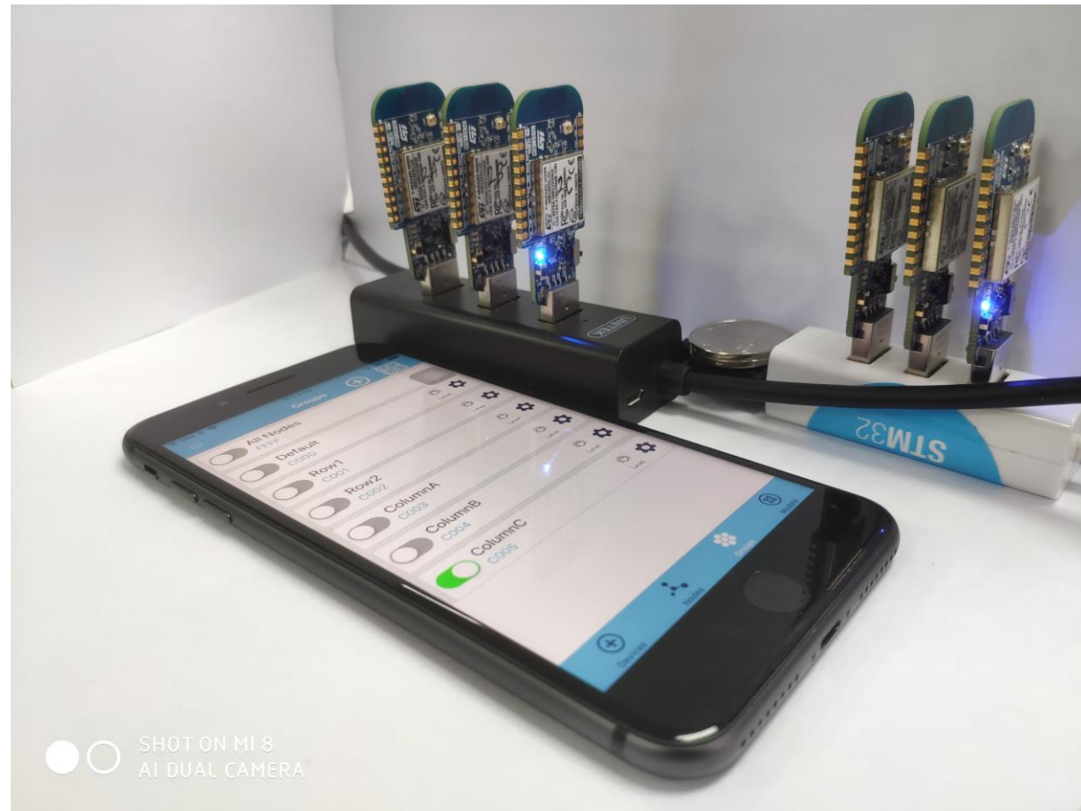
控制Mesh子网ColumnC中所有节点的LED灯的同时开
