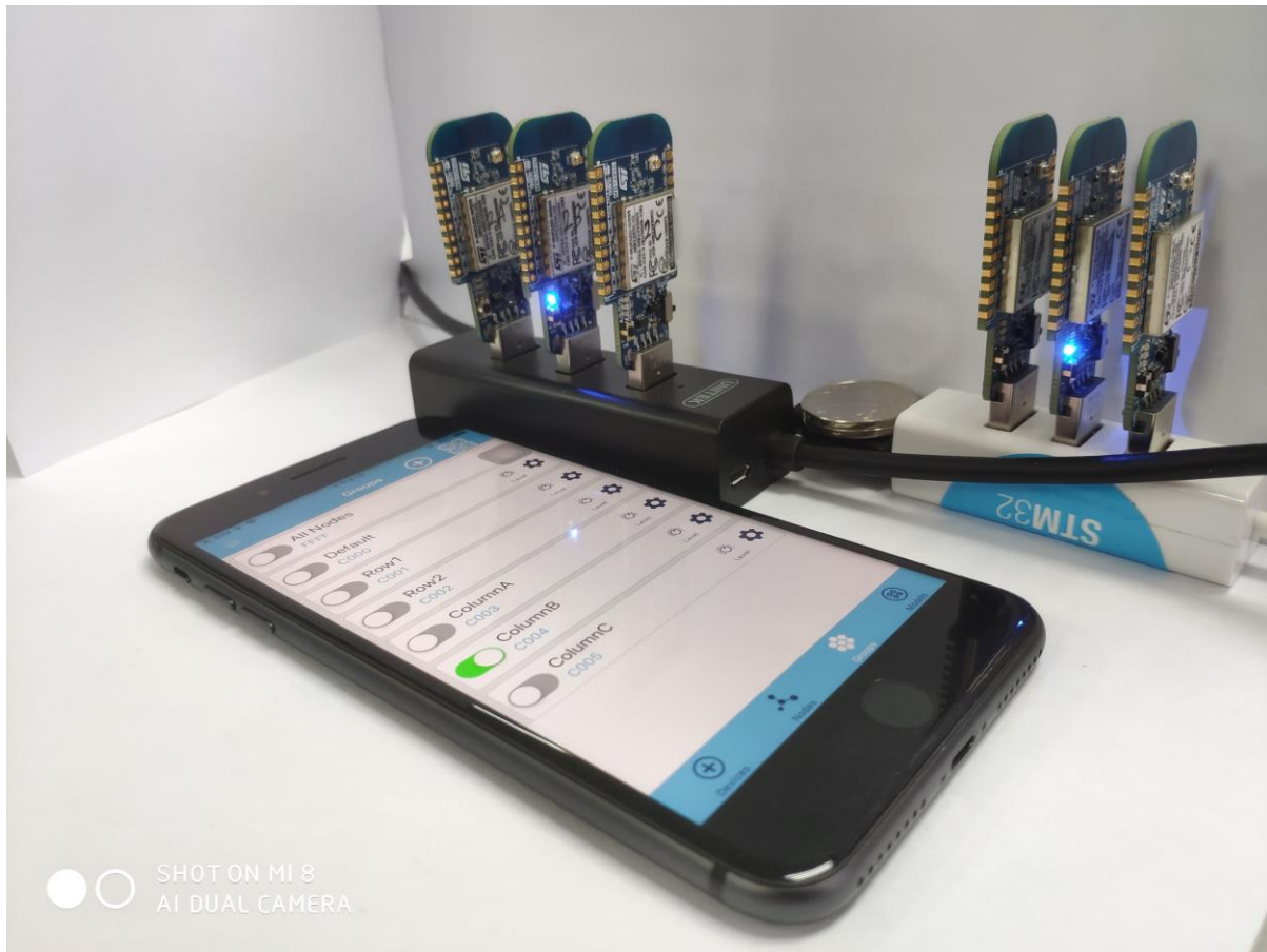
控制Mesh子网ColumnB中所有节点的LED灯的同时开
