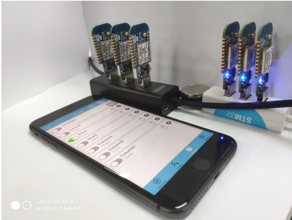
控制Mesh子网Row1中所有节点同时开灯
