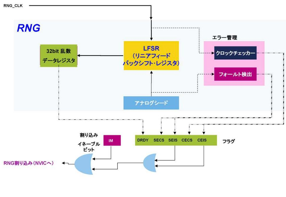
RNGのブロック図は、その基本機能とコントロールモジュールを示します。
