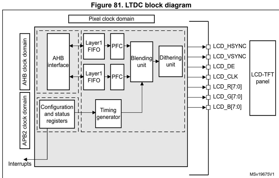
Layer FIFO: One FIFO 64x32 bit per layer.
