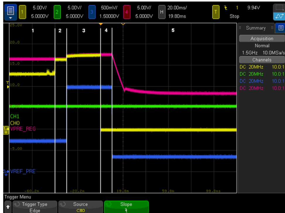
Figure 104. VREF_PRE_REG - open load
