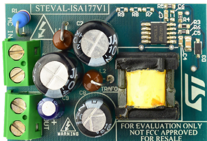
5V / 0.85Aフライバック・コンバータ評価ボード (STEVAL-ISA177V1)
