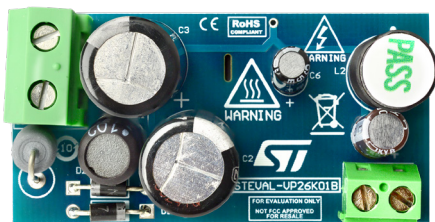
VIPer26Kをベースにした15V / 100mA高電圧 バック・コンバータ・リファレンス設計 (STEVAL-VP26K01B)
