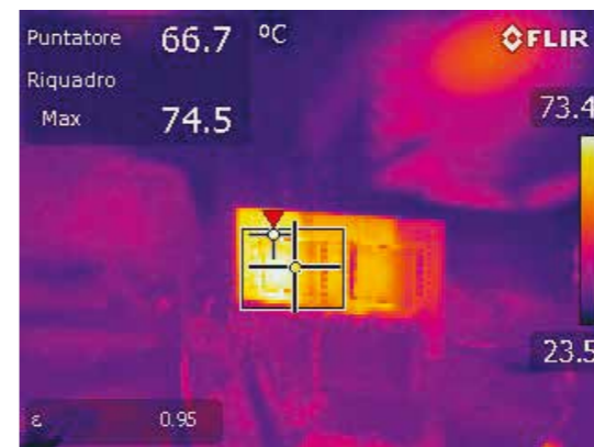
TO-LLパッケージの T_{CASE} (1.5kW時)
