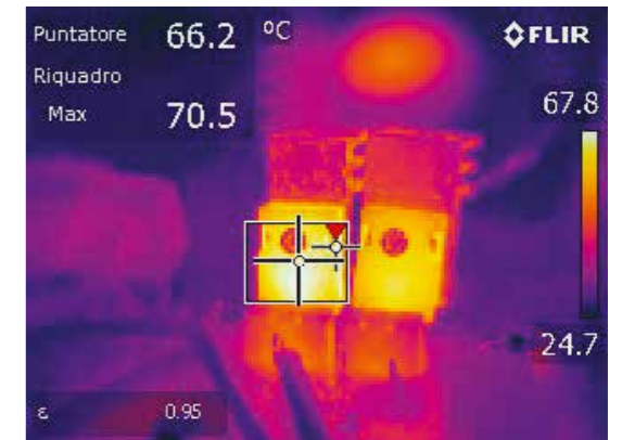
TO-247パッケージの T_{CASE} (1.5kW時)
