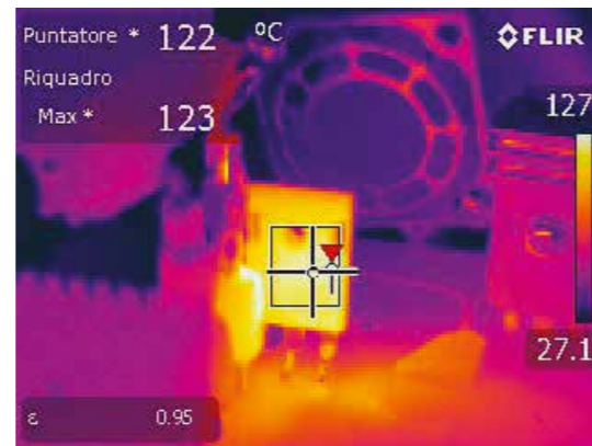
TO-247パッケージの T_{CASE} (1.5kW時)
