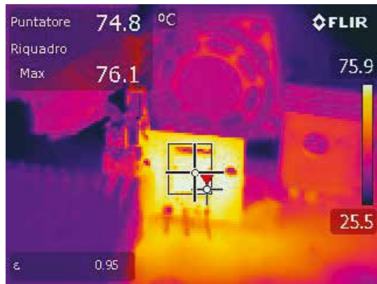
TO-LLパッケージの T_{CASE} (1.5kW時)
