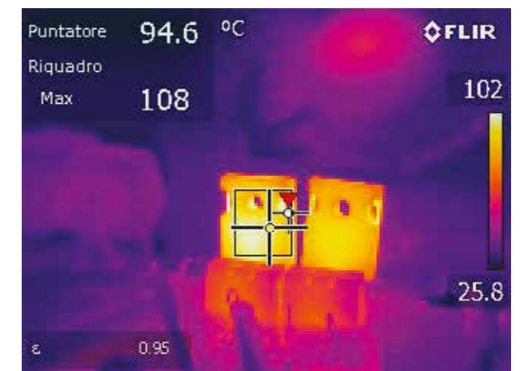
TO-247パッケージの T_{CASE} (1.5kW時)
