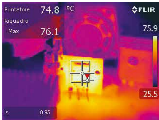
TO-LLパッケージの T_{CASE} (1.5kW時)
