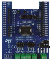
0.7Aの産業用負荷に接続されたデジタル出力モジュールでISO808オクタル・ハイサイド・スマート・パワー・ソリッド・ステート・リレー（ガルバニック絶縁内蔵）の駆動機能と診断機能を評価することを目的とした産業用デジタル出力拡張ボードです。
