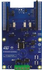
**X-NUCLEO-OUT07A1**は、0.5Aの産業用負荷に接続されたデジタル出力モジュールでIPS4260LMクワッド・ローサイド・スマート・パワー・ソリッド・ステート・リレーの駆動機能と診断機能を評価するために作られた、産業用デジタル出力拡張ボードです。
