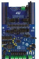
1.0Aの産業用負荷に接続されたデジタル出力モジュールでIPS8200HQ-1オクタル・ハイサイド・スマート・パワー・ソリッドステート・リレーの駆動機能と診断機能を評価することを目的とした産業用デジタル出力拡張ボードです。
