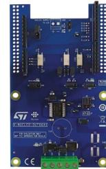
**X-NUCLEO-OUT08A1**は、2A（標準）デジタル出力モジュール用に作られた産業用デジタル出力拡張ボードで、IPS160HFシングル・ハイサイド・スイッチの安全駆動機能とスマート診断機能を備えています。
