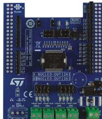
1.0Aの産業用負荷に接続されたデジタル出力モジュールでISO808-1オクタル・ハイサイド・スマート・パワー・ソリッド・ステート・リレー（ガルバニック絶縁内蔵）の駆動機能と診断機能を評価することを目的とした産業用デジタル出力拡張ボードです。
