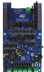
0.7Aの産業用負荷に接続されたデジタル出力モジュールでIPS8200HQオクタル・ハイサイド・スマート・パワー・ソリッド・ステート・リレーの駆動機能と診断機能を評価することを目的とした産業用デジタル出力拡張ボードです。
