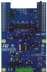
2.5Aの産業用負荷に接続されたデジタル出力モジュールでIPS1025HFシングル・ハイサイド・スマート・パワー・ソリッドステート・リレーの駆動機能と診断機能を評価することを目的とした産業用デジタル出力拡張ボードです。
