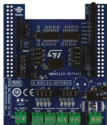
0.7Aの産業用負荷に接続されたデジタル出力モジュールでIPS8160HQオクタル・ハイサイド・スマート・パワー・ソリッド・ステート・リレーの駆動機能と診断機能を評価することを目的とした産業用デジタル出力拡張ボードです。
