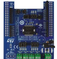
1.0Aの産業用負荷に接続されたデジタル出力モジュールでISO808A-1オクタル・ハイサイド・スマート・パワー・ソリッド・ステート・リレー（ガルバニック絶縁と20MHz SPI制御インターフェースを内蔵）の駆動機能と診断機能を評価することを目的とした産業用デジタル出力拡張ボードです。
