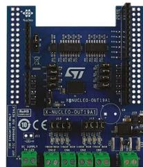
1Aの産業用負荷に接続されたデジタル出力モジュールでIPS8160HQ-1オクタル・ハイサイド・スマート・パワー・ソリッドステート・リレーの駆動機能と診断機能を評価することを目的とした産業用デジタル出力拡張ボードです。
