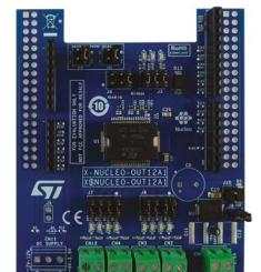
0.7Aの産業用負荷に接続されたデジタル出力モジュールでISO808Aオクタル・ハイサイド・スマート・パワー・ソリッド・ステート・リレー（ガルバニック絶縁と20MHz SPI制御インターフェースを内蔵）の駆動機能と診断機能を評価することを目的とした産業用デジタル出力拡張ボードです。
