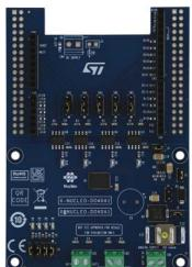
0.6A以下の産業用負荷に接続されたデジタル出力モジュールでIPS4140HQクワッド・ハイサイド・スマート・パワー・ソリッドステート・リレーの駆動機能と診断機能を評価することを目的とした産業用デジタル出力拡張ボードです。
