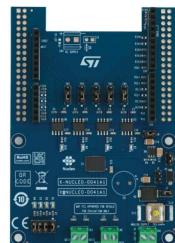
1A以下の産業用負荷に接続されたデジタル出力モジュールでIPS4140HQ-1クワッド・ハイサイド・スマート・パワー・ソリッドステート・リレーの駆動機能と診断機能を評価することを目的とした産業用デジタル出力拡張ボードです。
