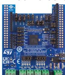
**X-NUCLEO-OUT03A1**は、2.5A(最大)の産業用負荷に接続されたデジタル出力モジュールでIPS2050H(デュアルハイサイド・スマート・パワー・ソリッドステート・リレー)の駆動機能と診断機能を評価するために作られた、産業用デジタル出力拡張ボードです。
