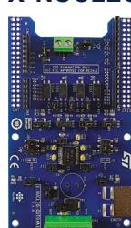
**X-NUCLEO-OUT05A1**は、2.5Aの産業用負荷に接続されたデジタル出力モジュールでIPS1025Hシングル・ハイサイド・スマート・パワー・ソリッド・ステート・リレーの駆動機能と診断機能を評価するために作られた、産業用デジタル出力拡張ボードです。
