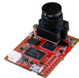
STM32H743マイコンが組み込まれた OpenMV Cam H7マシン・ビジョン・ボード
