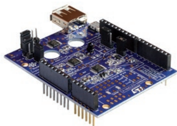
多機能拡張ボード オペアンプをベースとする多機能拡張ボード
