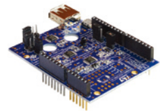
X-NUCLEO-IKA01A1 STM32 Nucleo向けオペアンプ多機能拡張ボード (TSZ124, TSU104, TSV734)
