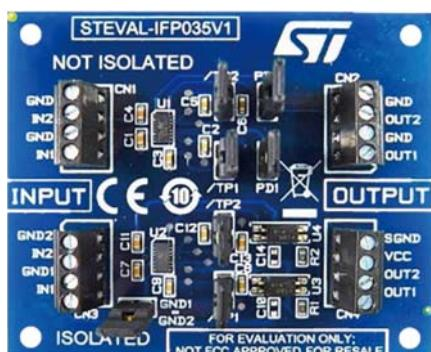
STEVAL-IFP035V1評価ボードは、産業用センサ・デバイスと、プログラマブル・ロジック・コントローラ (PLC) などの処理ユニットの間でデジタル入力カレント・リミッタを使用するファクトリ・オートメーションの回路保護機能を評価できるように設計されています。このボードは、2つの独立した CLT03-2Q3 自己給電式デジタル入力カレント・リミッタを搭載しています。
