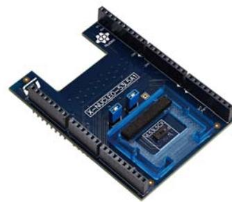
2枚のVL53L5CXブレークアウト・ボードのセット (VL53L5CX-SATEL) は、開発者がVL53L5CXセンサをプロトタイプに容易に組み込み、製品開発期間を短縮する上で役立ちます。
