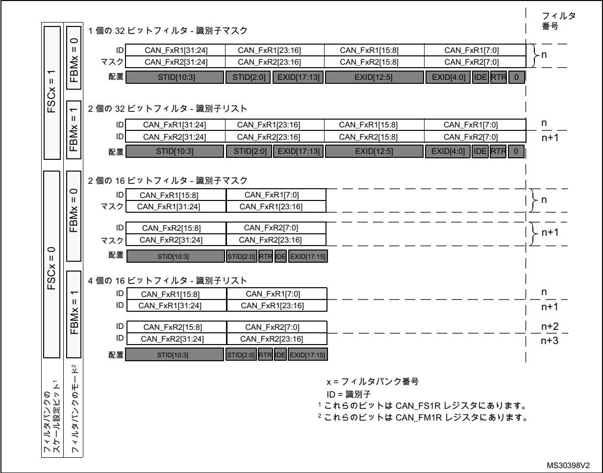
図 326. フィルタバンクのスケール設定 - レジスタ構造
