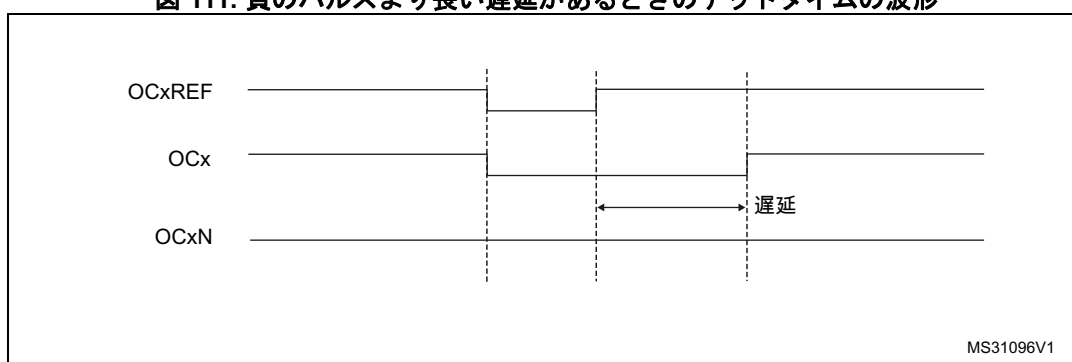
図 112. 正のパルスより長い遅延があるときのデッドタイムの波形
