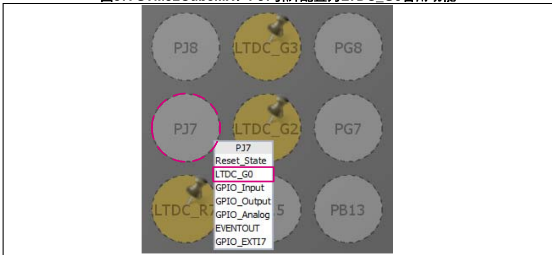
图37. STM32CubeMX：PJ7引脚配置为LTDC_G0备用功能
