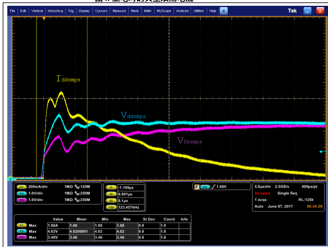
图4. 上电时的典型浪涌电流
