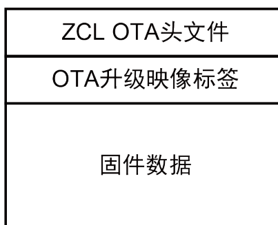
图 19. Zigbee FUOTA 的 OTA 文件格式
