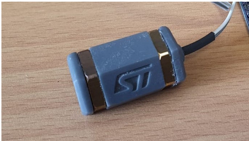
图 10. 用于漏水检测的电极示例
