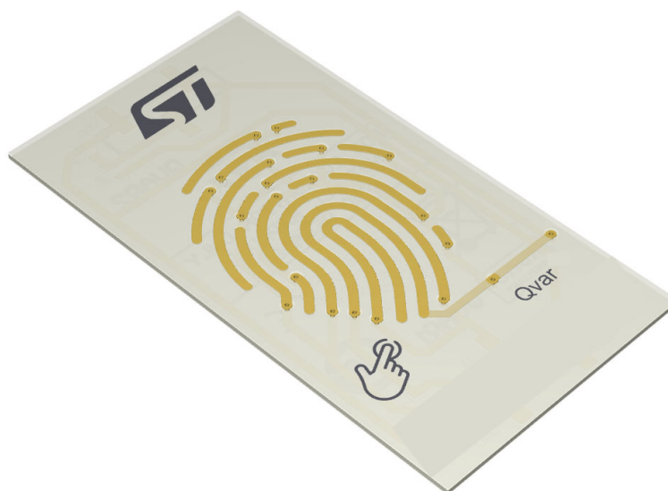
图 8. 用于触摸检测的 PCB 电极示例
