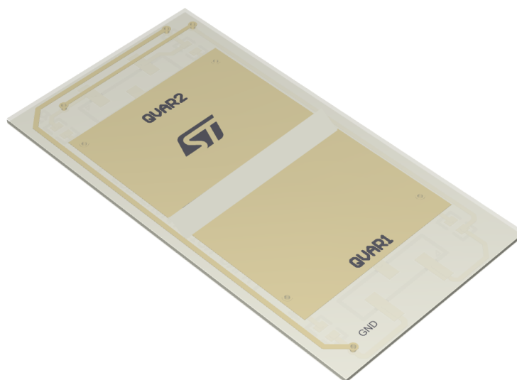
图 16. 用于雷达应用的 Qvar 电极
