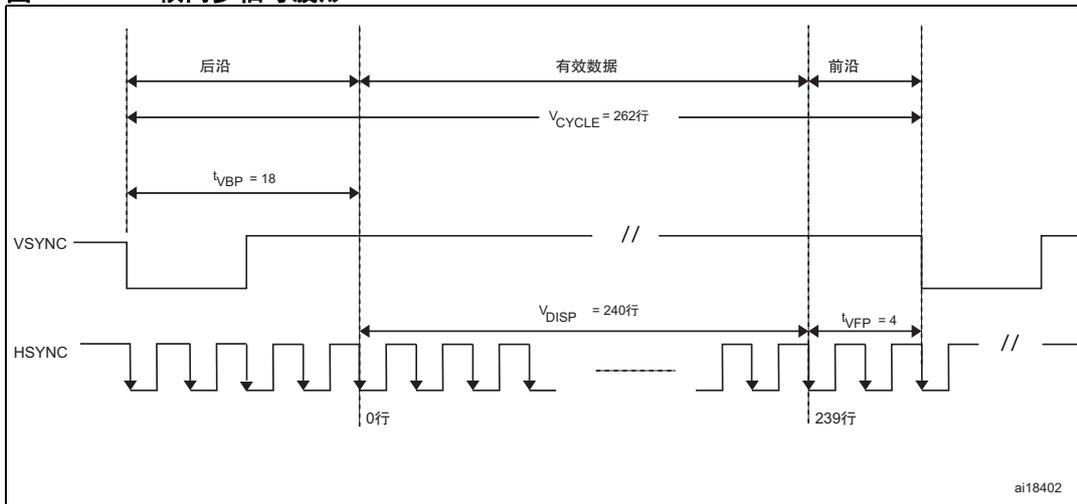
图 3. TFT 线同步信号波形
