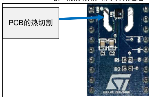
图 8: PCB (HTS221 DIL24 板) 的热切割, 用于降低通过 PCB 的热传播
