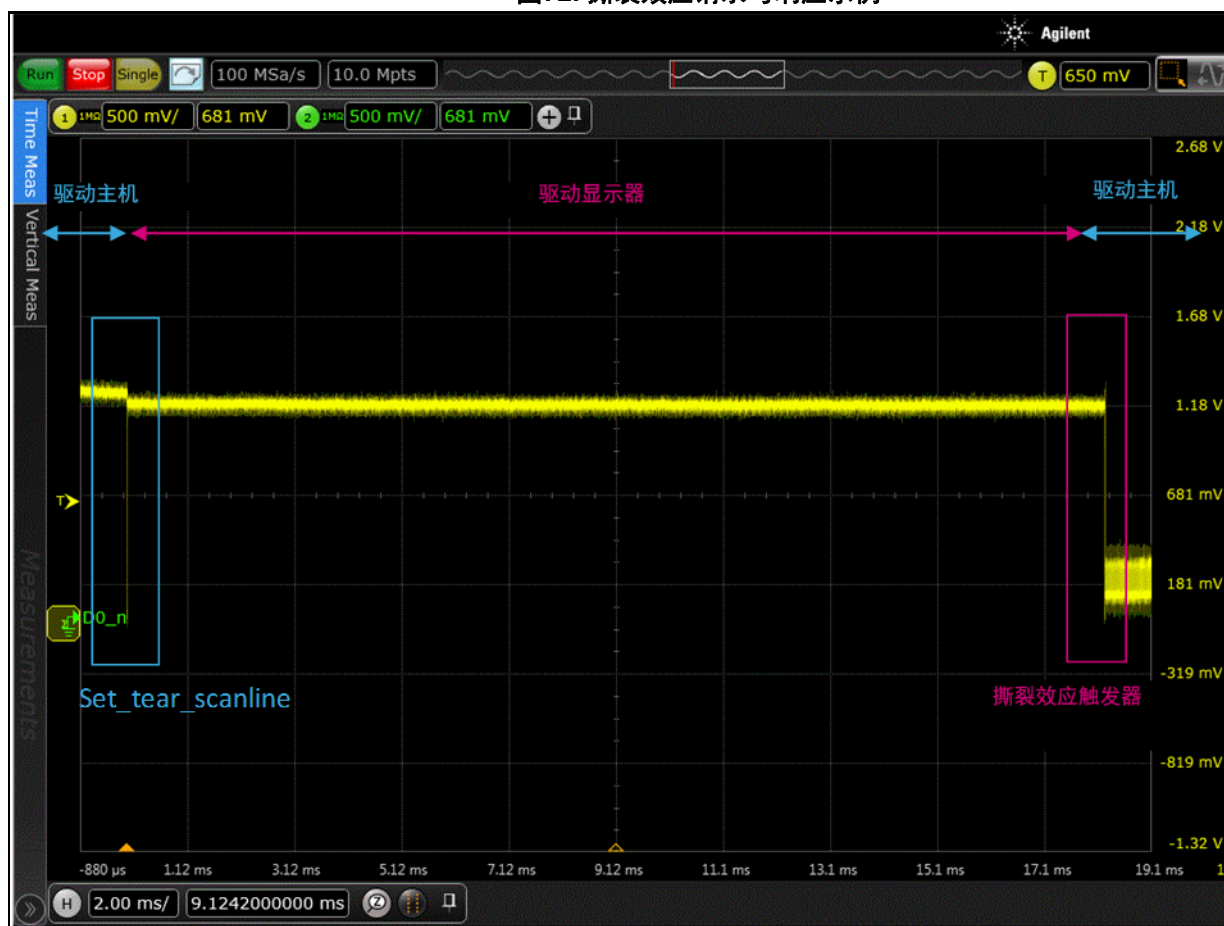
图72. 撕裂效应请求与响应示例
