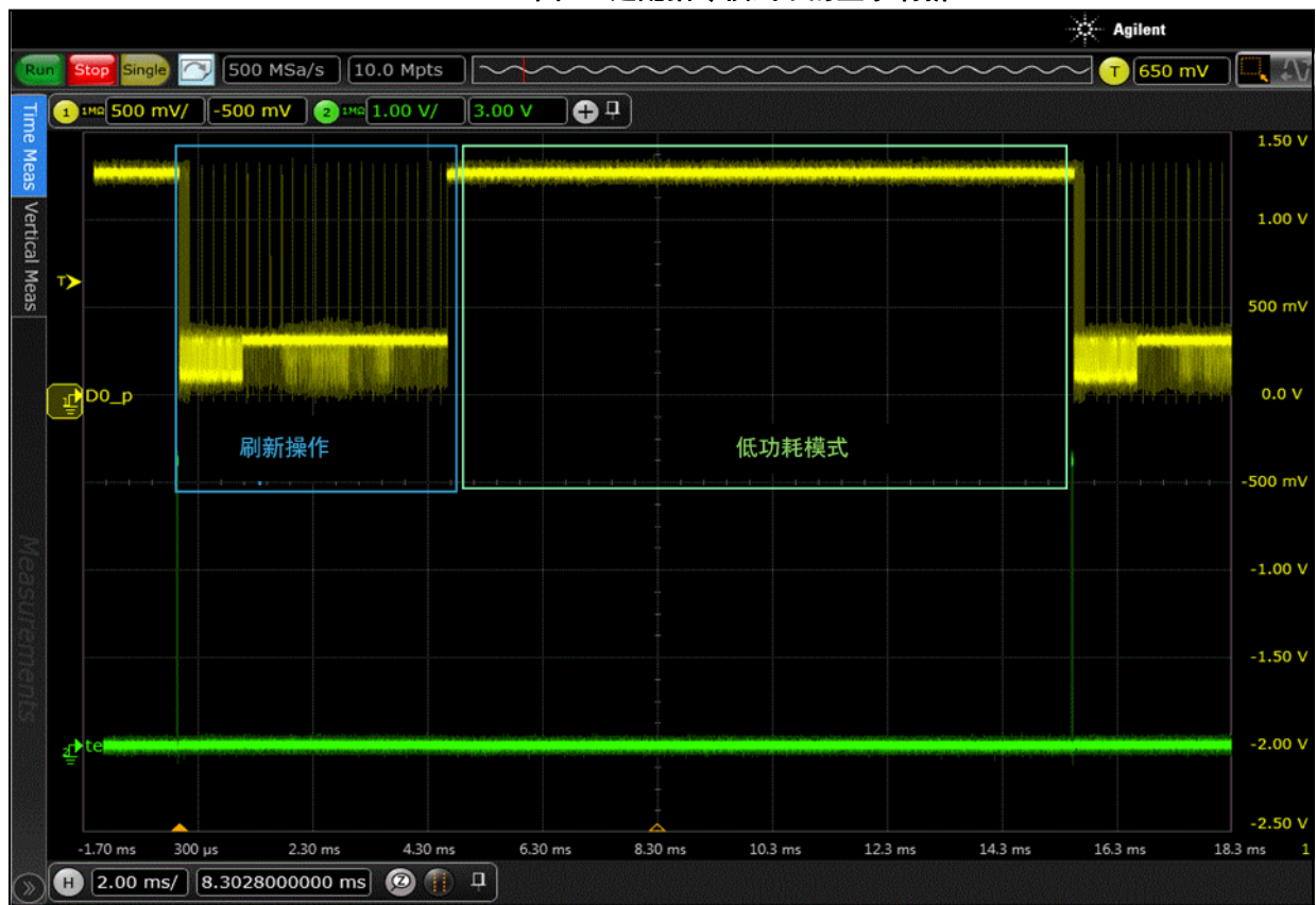
图71. 适配指令模式下的显示刷新
