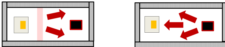
图 6. 传感器外壳顶视图：左侧为具有隔热措施的正确设计，右侧为错误设计
