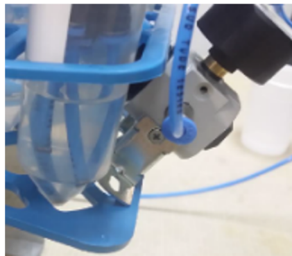
图 14. 四个 LPS33HW 浸入 3 毫米的管子，用于测试空气超压
