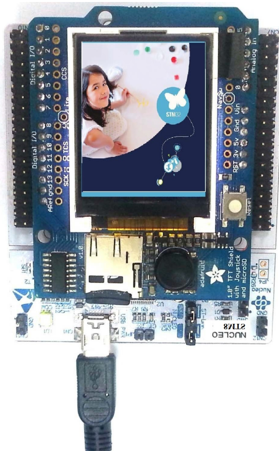
图 8. STM8 Nucleo-64 板上应用运行样例
