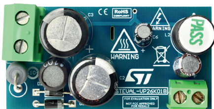
基于VIPER26K (STEVAL-VP26K01B) 的 15V/100mA高压降压转换器参考设计
