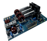
STDES-30KWVRECT 带有数字控制的30 kW Vienna PFC整流器参考设计
