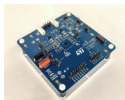
STEVAL-WLC98RX 符合Qi标准的无线功率接收器，支持50 W应用
