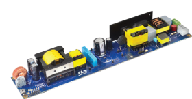
STEVAL-ILL066V2 带DALI2.0通信接口的100 W LED街道照明使用STLUX385A数字控制器
