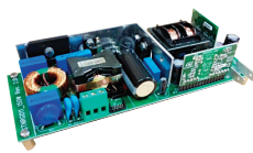
EVLSTNRG011-150 EVL011A150ADP 12 V - 150 W电源, 基于TM PFC和 HB LLC数字组合控制器
