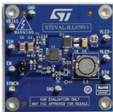
STEVAL-ILL078V1 基于LED6000的1 A、至高60 V Vin降压LED驱动板
