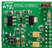
STEVAL-ILM001V1 插入式硬件模块，用于STM8S-DISCOVERY接口，可用于DALI通信
