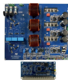
STDES-VRECTFD 15 kW，三级，三相Vienna整 流器（配用于功率因素校正的 数字控制）
