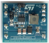
STEVAL-ILL056V1 基于LED5000的3 A降压LED 驱动板
