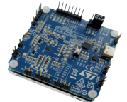
STEVAL-WLC38RX 符合Qi标准的无线功率接收器，支持BPP 5W、EPP 15 W应用
