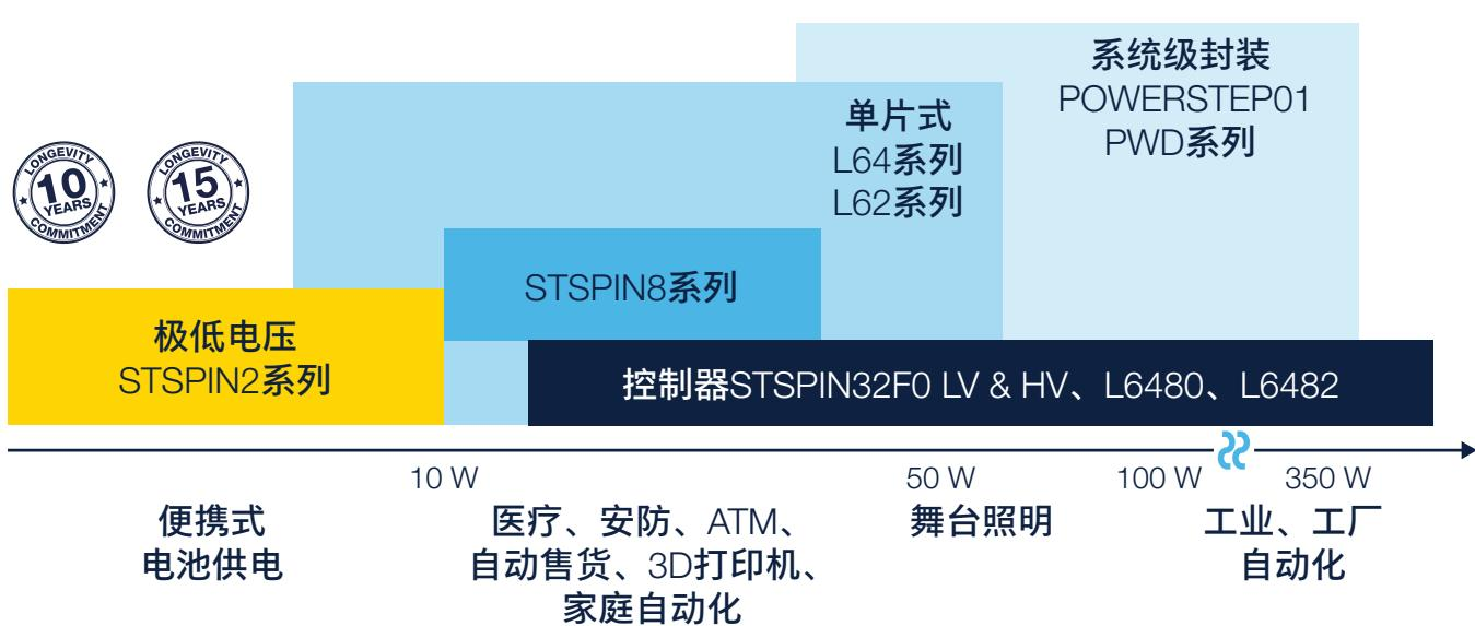
用于有刷直流电机控制的Nucleo扩展板按工作范围和系列分类。使用该图示选择最合适的工作范围（基于要使用的电机的工作范围）。该并行模式（如果支持）将一些电机板件转换为单刷直流驱动器，使输出电流能力翻倍。
