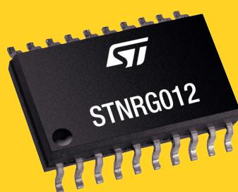
STNRG012提供各种功能块的复杂控制，以确保所有负载间的高效转换和高度可调输出，以及交流和直流电压输入之间的平滑过渡。该器件包含多模（过渡和不连续导通）PFC控制器、用于LLC谐振半桥的高压双端时移控制器和800 V启动发生器。
